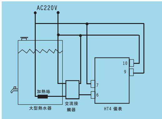
例二：若儀表確實需要用在干擾很強烈的環境下，採用下圖接法可增強電源抗干擾性能
